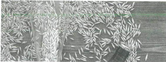
Los granos de cereal pasan por un proceso de germinación controlada con el objeto de activar las enzimas existentes en el grano.
